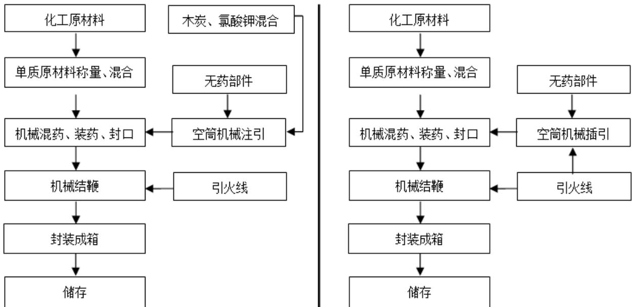
图 2.3-1 爆竹类产品生产工艺流程图
